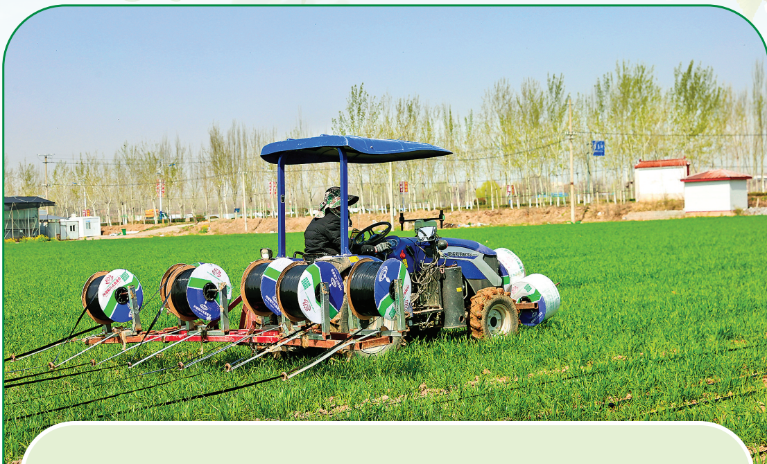
日前,夏县裴介镇一麦田里,工人操作农机在铺设节水滴灌带。近年来,夏县积极推广滴灌等节水灌溉技术,在节约水资源的同时提升农作物抗旱能力,助力农业增产增收。 特约摄影 张秀峰 摄
