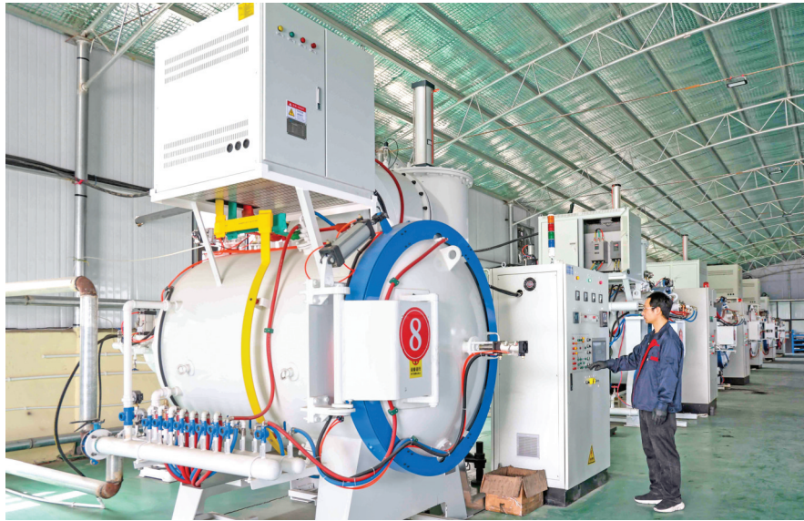
▲工人在操作真空钎焊炉 记者 茹雅 摄
